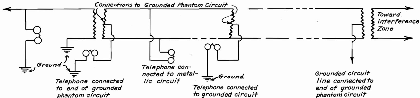
**SCHMATIC DIAGRAM SHOWING CONNECTIONS FOR A GROUNDLED PHANTOM CIRCUIT**
