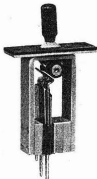
2172-A Clé d'appel et d'écoute. Le côté d'appel ferme 2 contacts et en rompt 2: le côté d'écoute en ferme 3 et en rompt 2. La pièce de fixation est en métal nickelé et poli. Employée dans les commutateurs standards.
