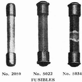
5022-M Fusible pour protecteur N° 5005 composé d'un fil fusible renfermé dans un tube en verre avec douilles en métal nickelé. Supporte indéfiniment un courant de 5,3 ampères. Longueur : 53 mm
