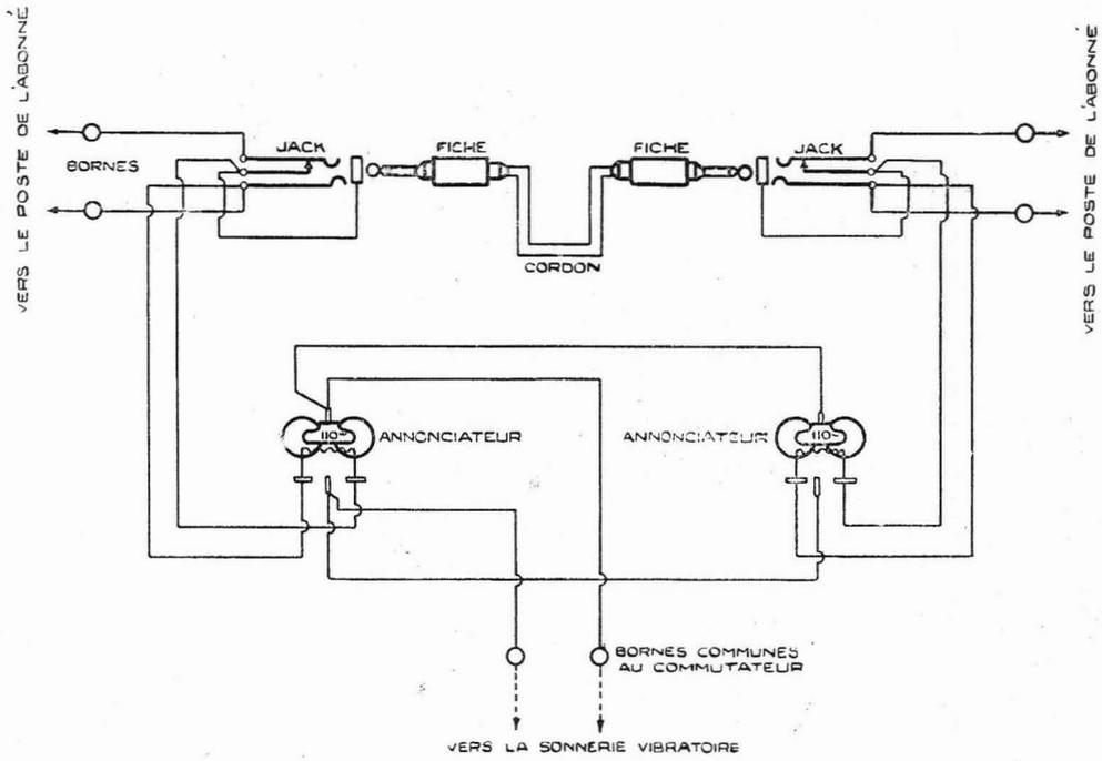
Schéma des connexions du commutateur Pony No. 2011
