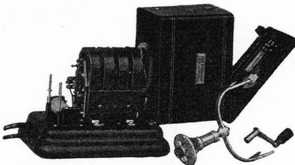
Dans certains postes, le microphone et le récepteur sont combinés en un seul organe appelé microtéléphone. Le microphone étant du type à capsule, peut être enlevé et remplacé sans devoir toucher aux connexions des conducteurs.
