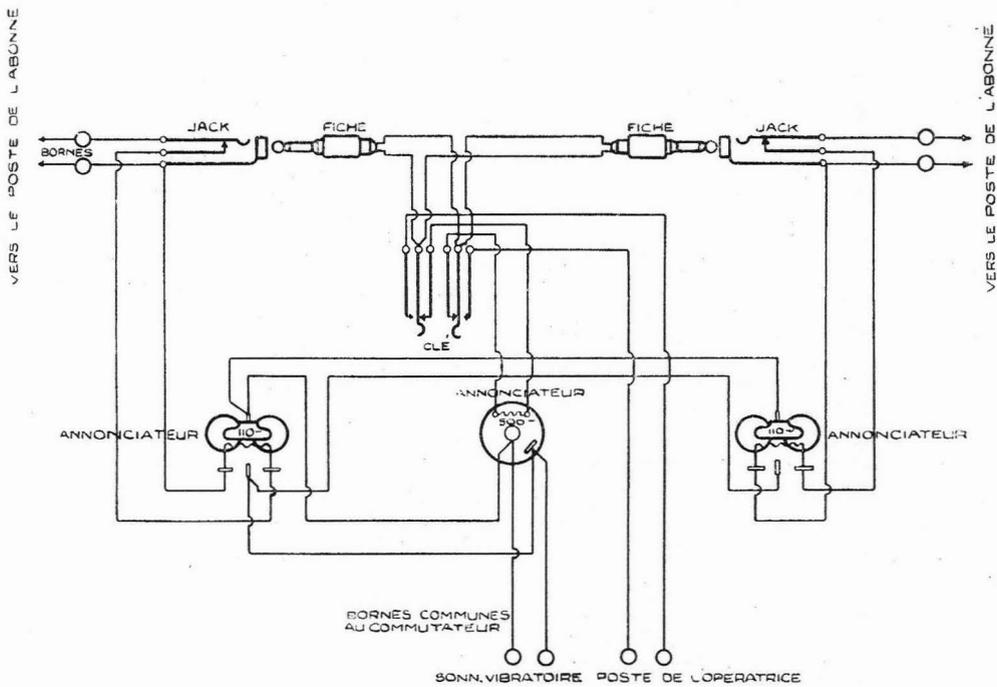
Schéma des connexions du commutateur Pony No. 2012
