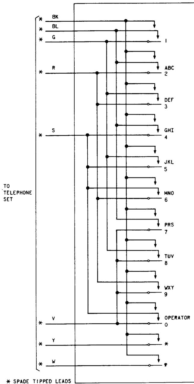
Fig. 3—28A Dial—Schematic
