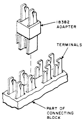
Fig. 14—183B2 Adapter, Installation Detail
