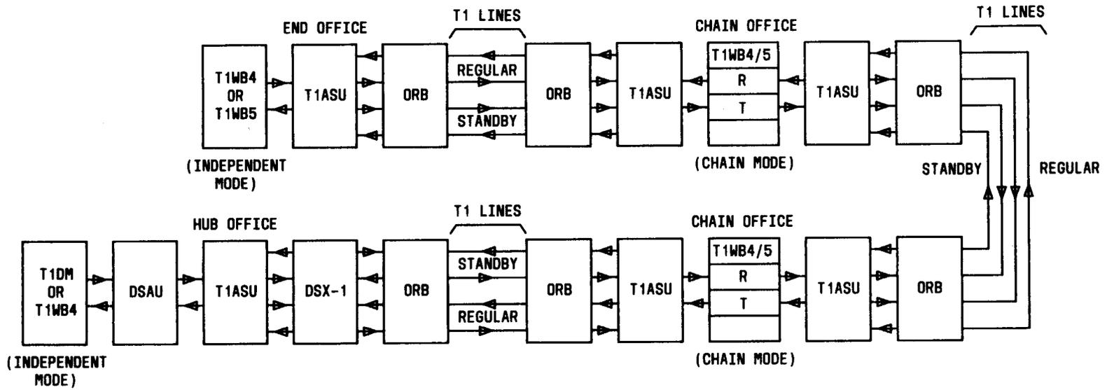
C. CHAIN OPERATION (DATA ONLY) WITH EITHER T1DM OR T1WB4 AT HUB OFFICE
