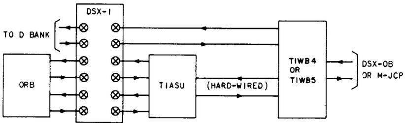
C. TYPICAL CROSS-CONNECTION FOR TI LINE USING COMBINED DATA-VOICE OPERATION
