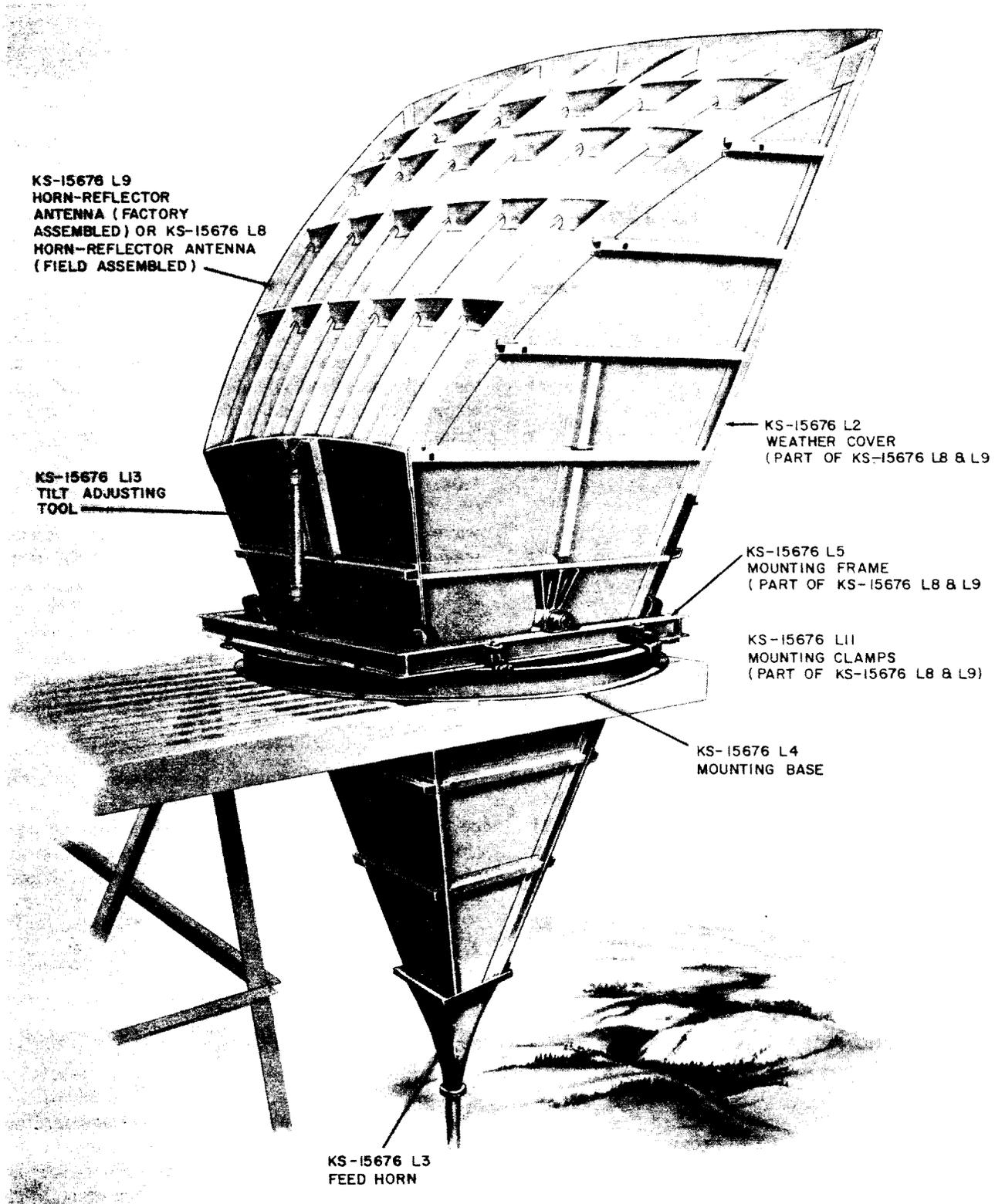
Fig. 1—KS-15676 L8, L9 Horn Reflector Antenna
