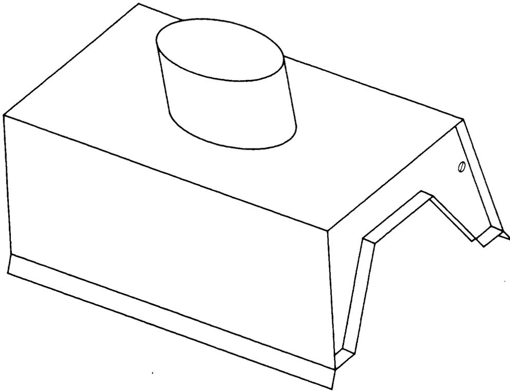
Fig. 1 —KS-21344 Air Diffuser
