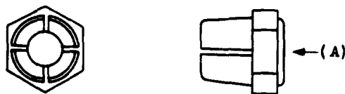
Fig. 14 - Adjusting Stud Nut — 13/64 inch
