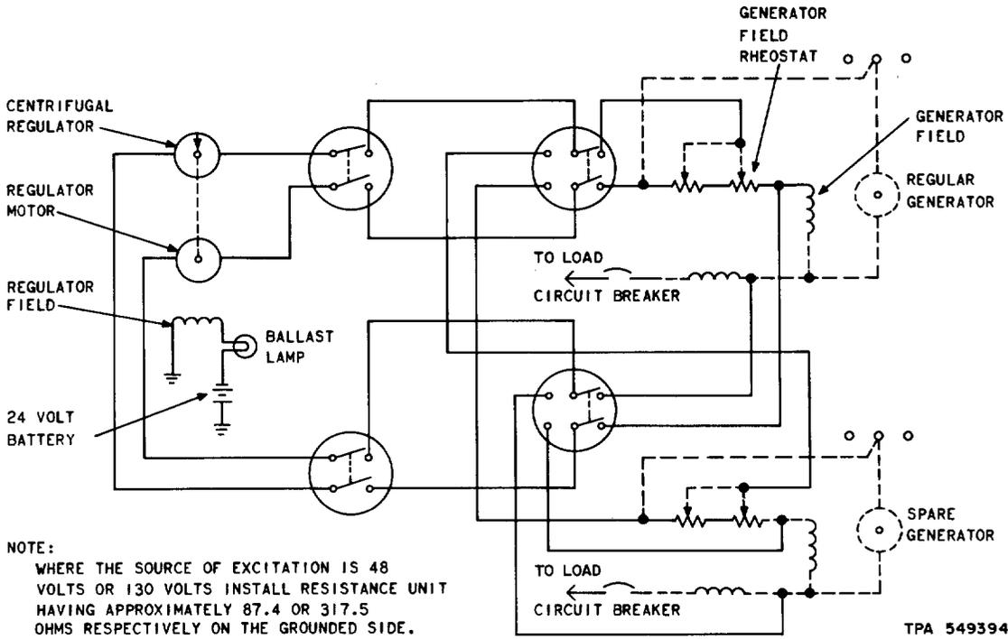
Fig. 5—24-Volt Filament or 130-Volt Plate Regulating Circuit
