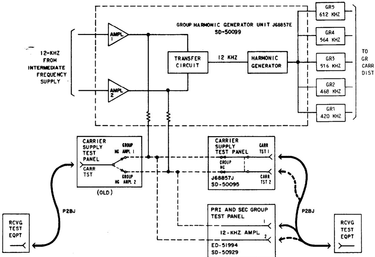
Fig. 4—12-kHz Amplifier Output Power Test
