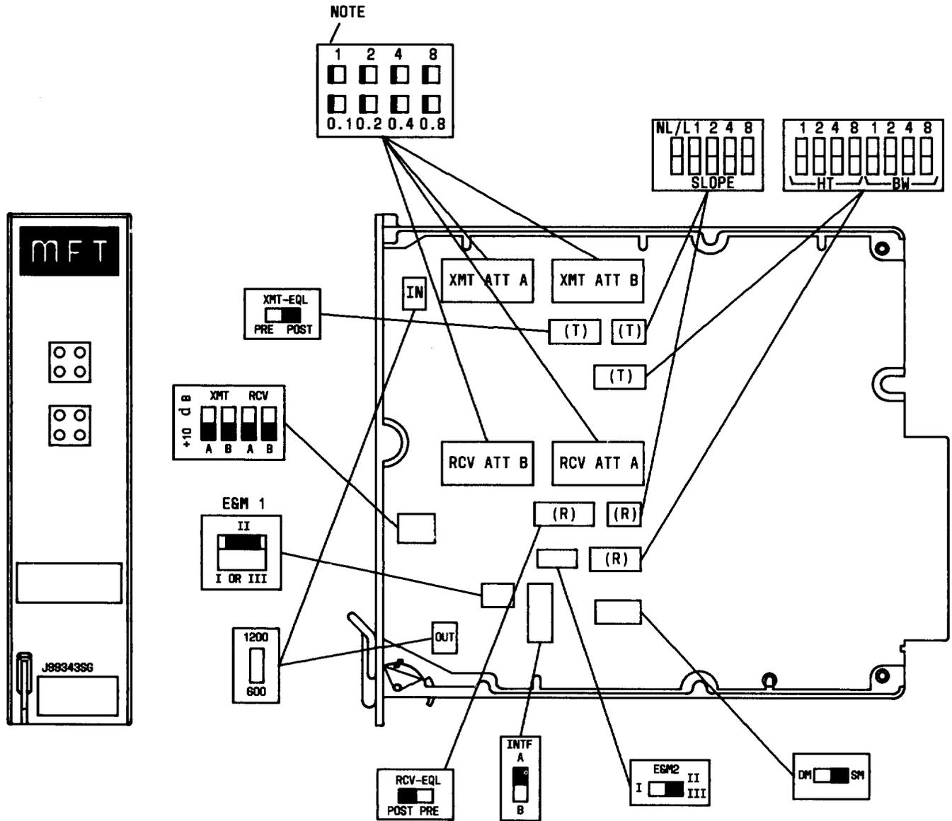
NOTE: LABEL FOR ATTENUATORS IS LOCATED ON TOPSIDE (NOT ON FRONT).
