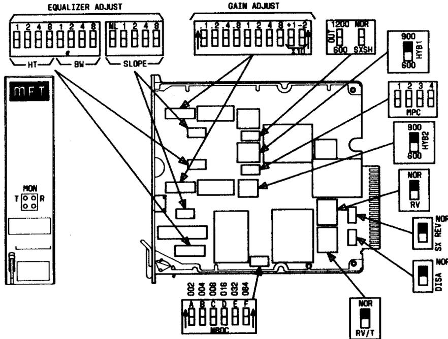
Fig. 2—J99343RF-1, L2 Component Layout
