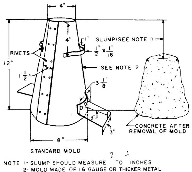
Fig. 5—Slump Test
