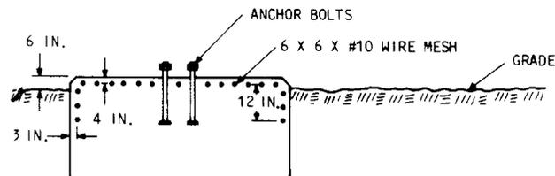
TYPICAL FOUNDATION FOR GUYED TOWER OR WAVEGUIDE SUPPORT
