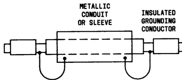
Fig. 4—Conduit Bonding
