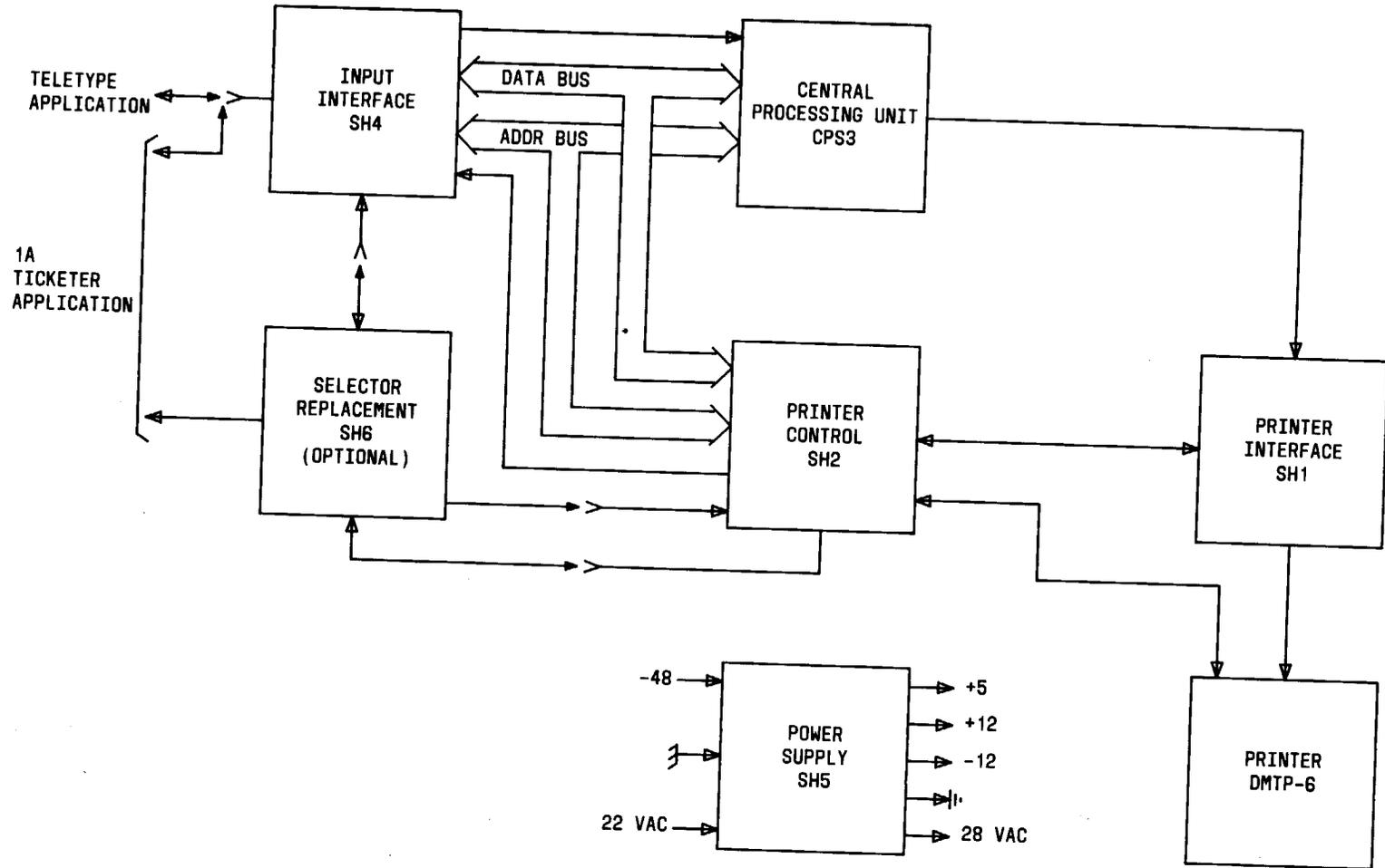
Fig. 5—Block Diagram
