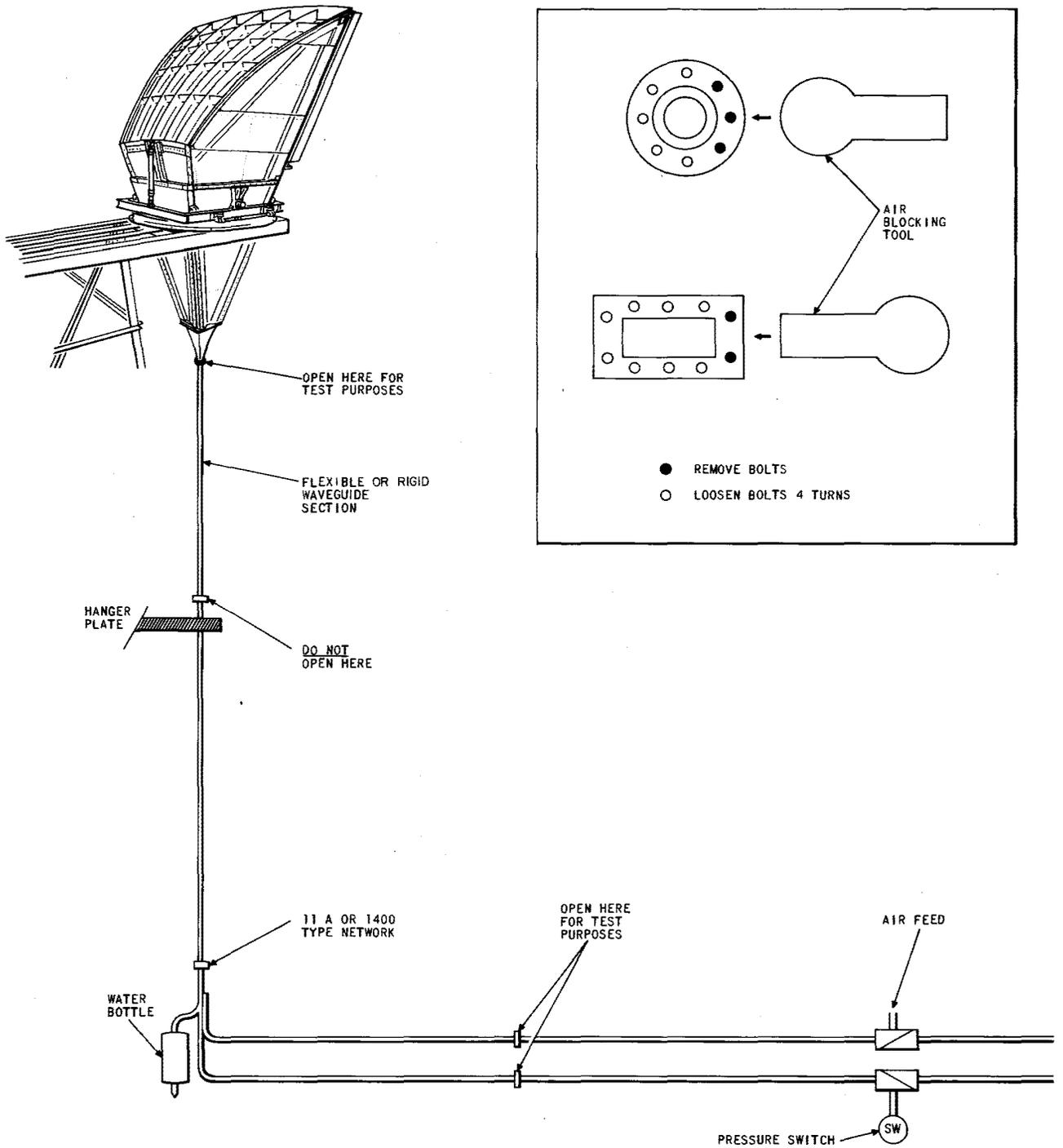
Fig. 5—Use of Air Blocking Tool
