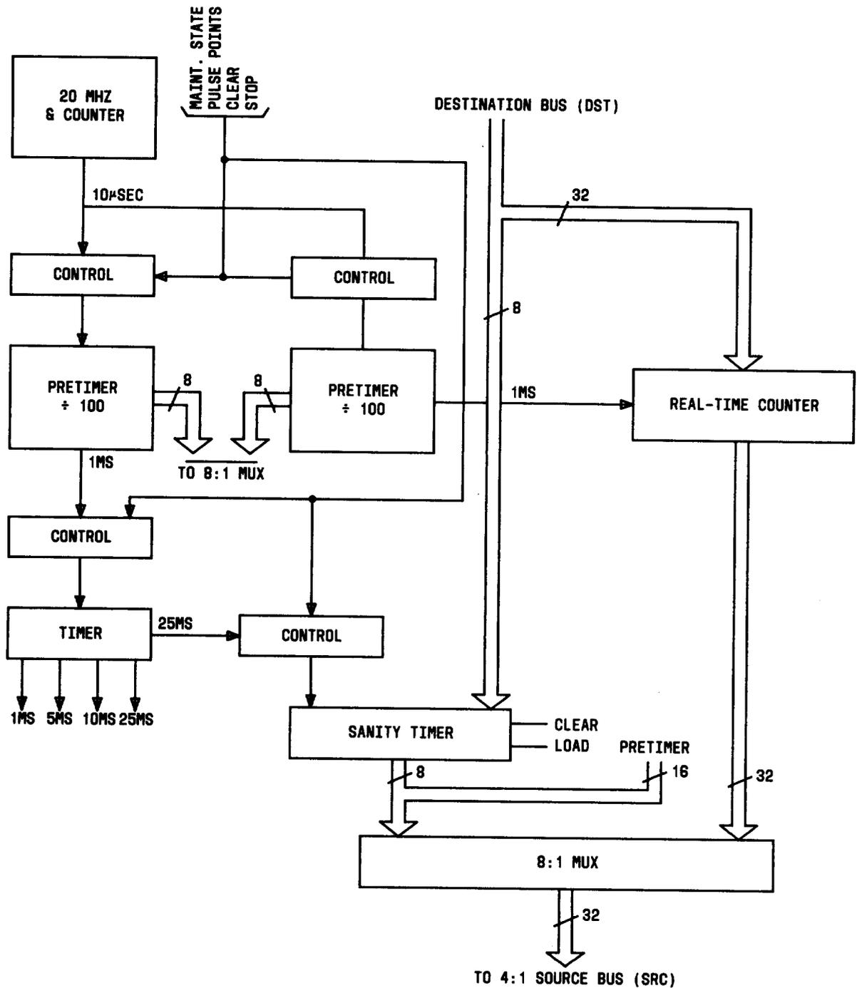
Fig. 16—CC Clock Circuits
