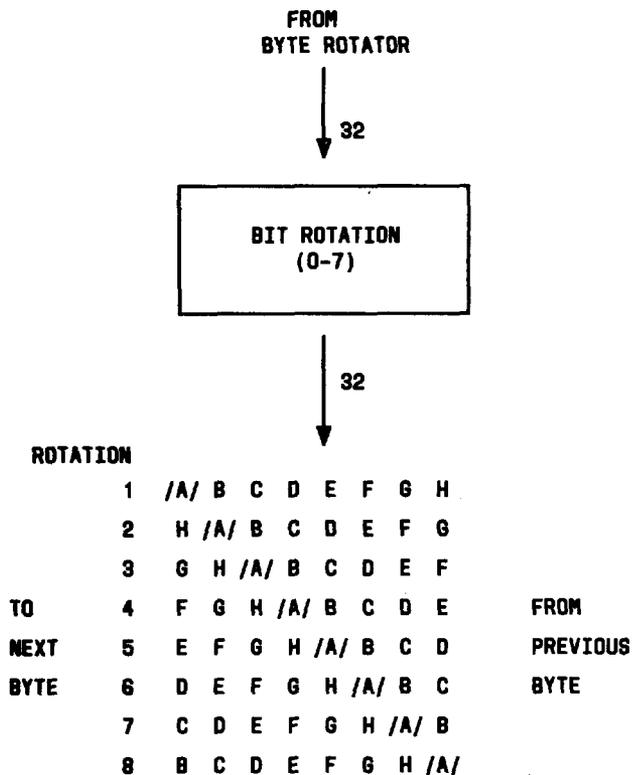
Fig. 13—Bit Rotator
