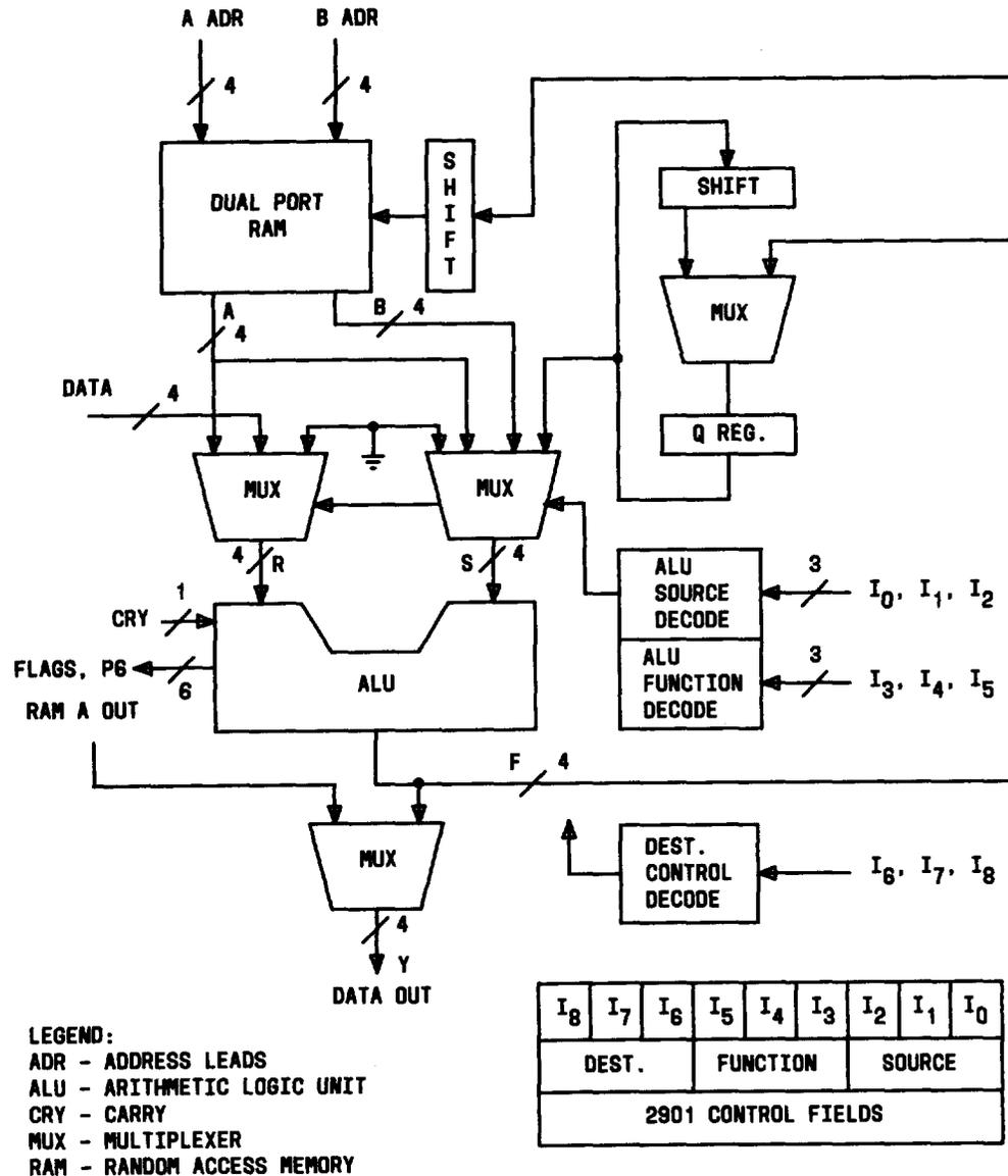
Fig. 23—Block Diagram 2901A
