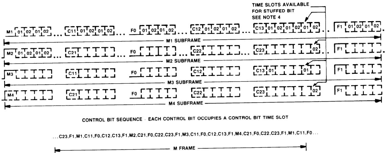
CONTROL BIT SEQUENCE - EACH CONTROL BIT OCCUPIES A CONTROL BIT TIME SLOT
