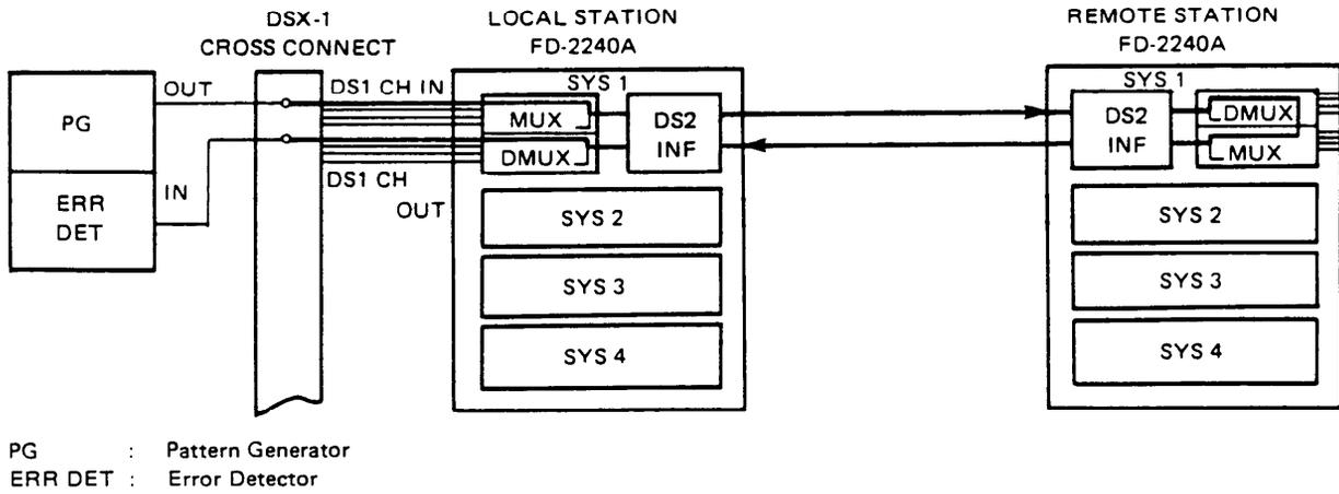
◆ Figure 4-2 Remote Loopback Configuration with DS2 Interface ◆
