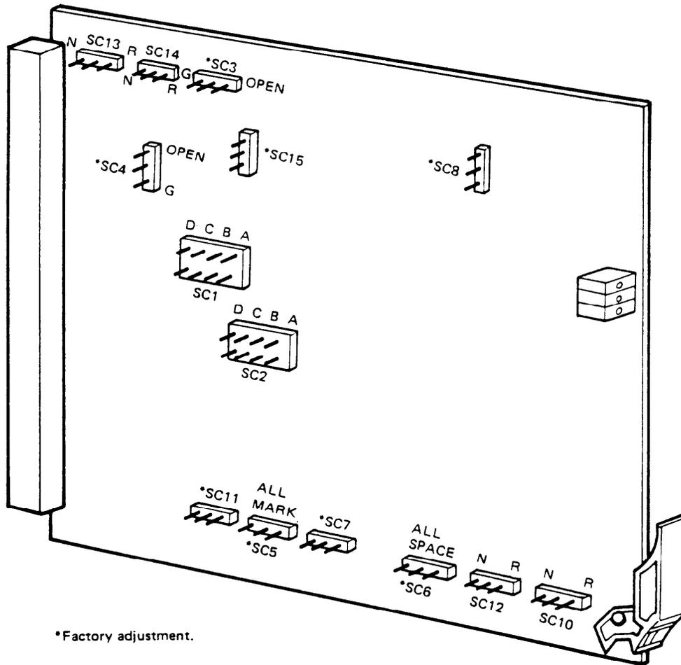
◆ Figure 5-9 DS2 INF Unit (Grp: 0A01/0B00) Straps Location (Sheet 1 of 2) ◆
