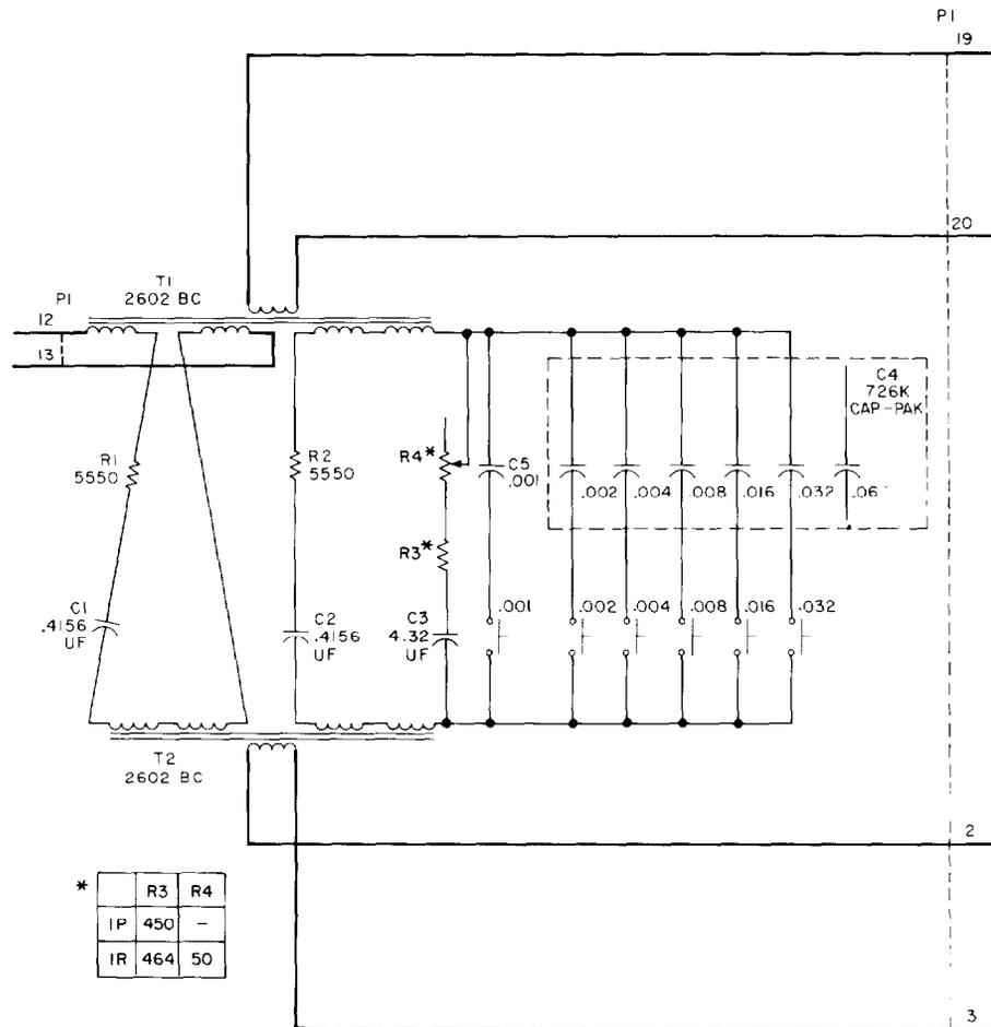
Fig. 2—1P/1R Terminating Set Schematic
