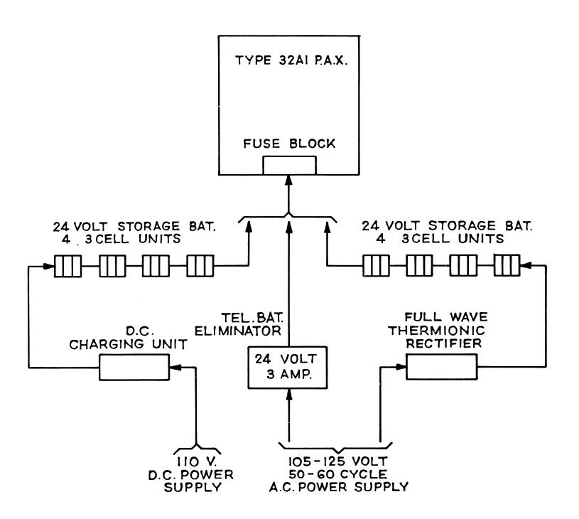
FIG. 1 ALTERNATIVE POWER ARRANGEMENTS
