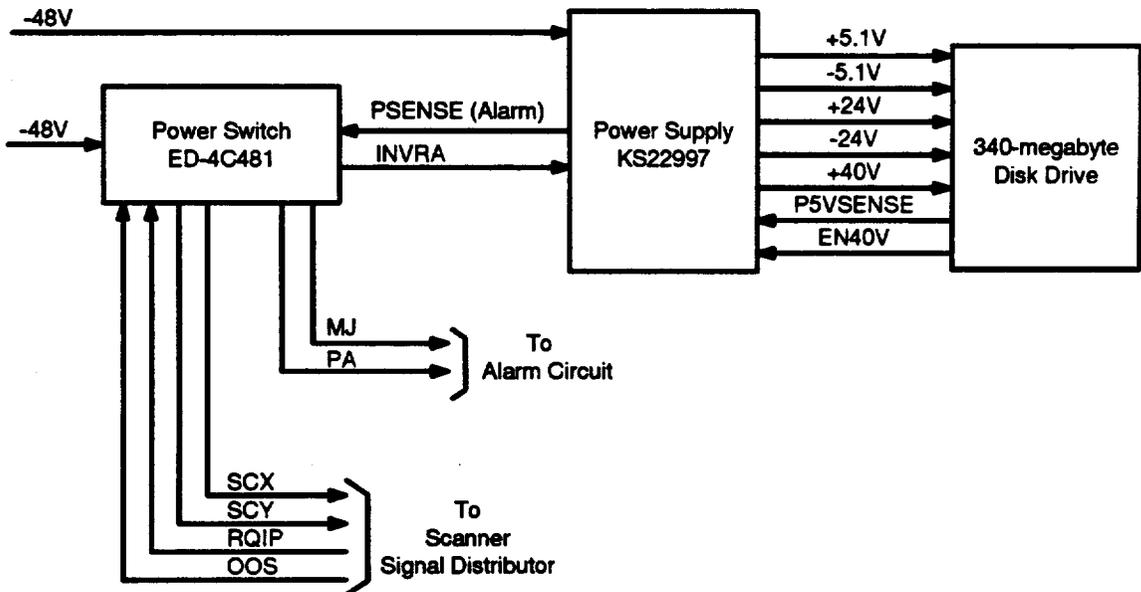
**Figure 27. 340-Megabyte Disk Drive Power Block Diagram**
