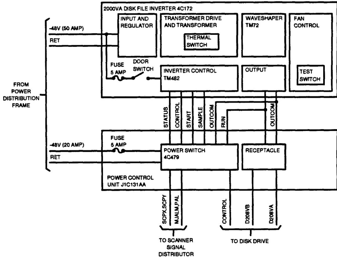
**Figure 28. 300-Megabyte Disk Drive Power**
