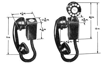
FIG. 1—211-TYPE MANUAL FIG. 2—211-TYPE DIAL
