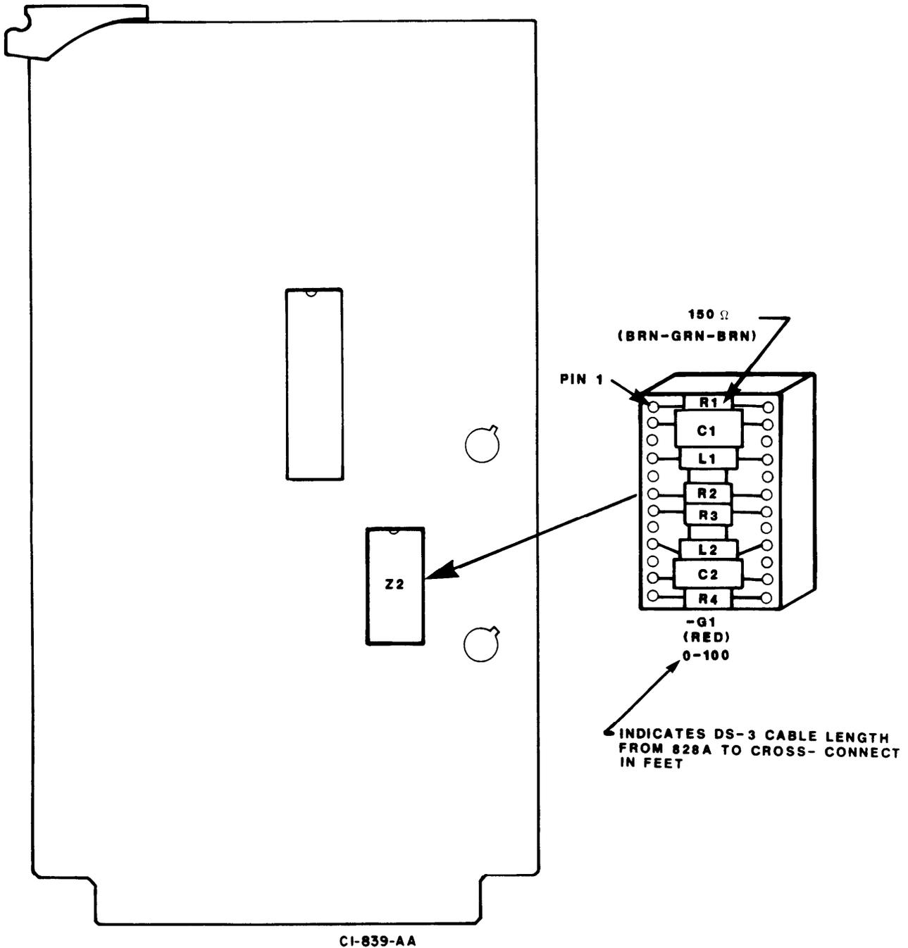
Figure 2E-5. Build-Out Module Orientation
