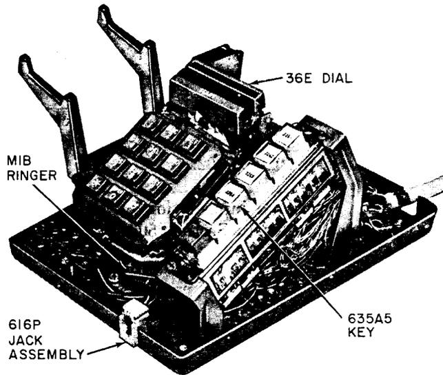
Fig. 2—2662A1M Telephone Set Base
